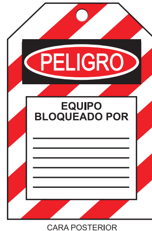
Ilustración 10 Ejemplo de señalización para el bloqueo
